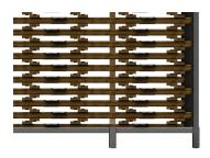
Le panneau suivant est placé dos à dos avec le premier panneau en quinconce de 5 cm. De cette façon, les panneaux reposent sur les lattes et non sur la bande de mousse. Le troisième panneau est maintenant placé directement sur le dessus et face à face sur le deuxième panneau.
